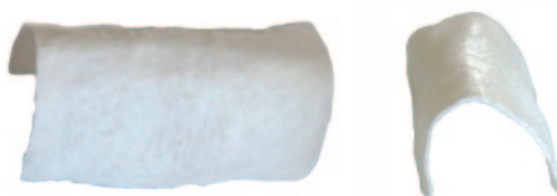
Lámina curva: 35x35mm. Espesor (0,8-1,0mm)
